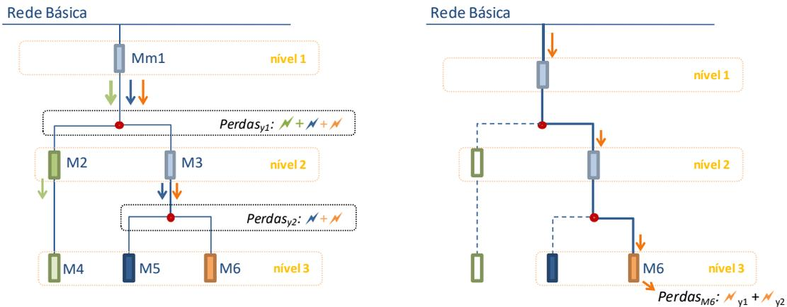
Figura 6: Representação da determinação de perda por rede compartilhada (esquerda) e o caminho em que o ponto de medição está associado para obtenção da perda por ponto de medição (direita)
