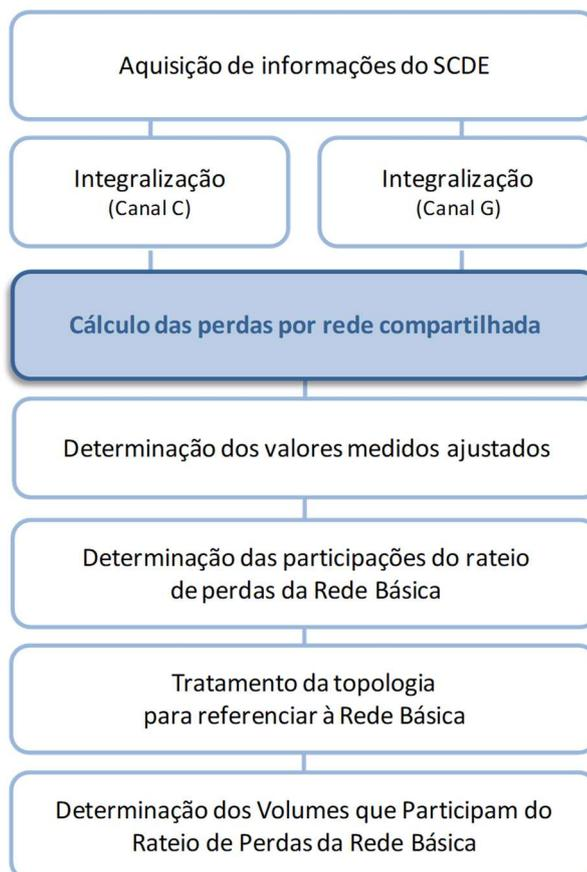
Figura 13: Esquema Geral do Módulo de Regras: “Medição Física”
