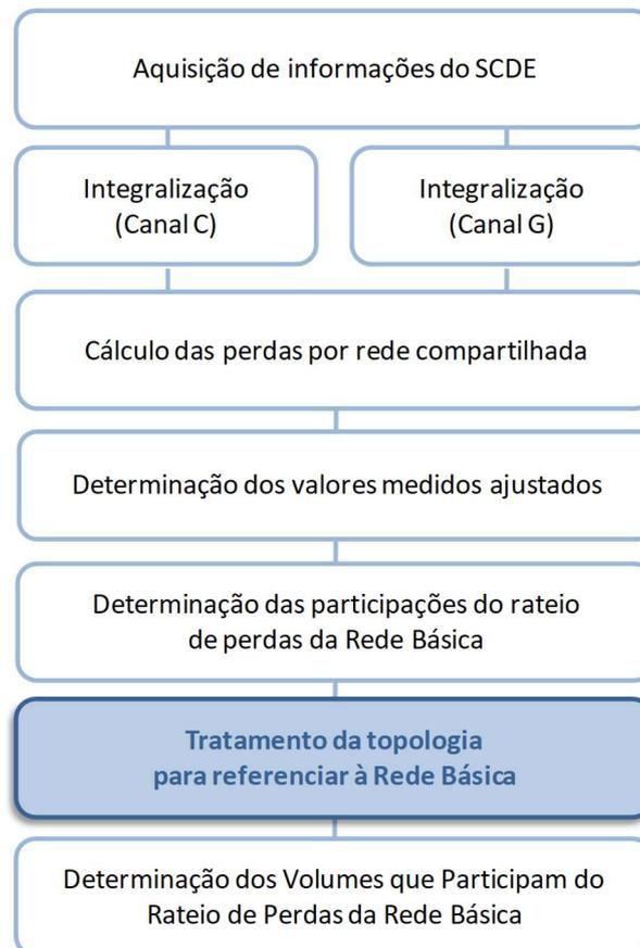
Figura 19: Esquema Geral do Módulo de Regras: "Medição Física"
