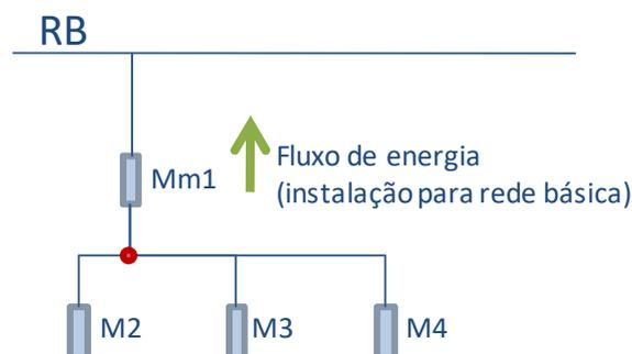
Figura 16: Representação do fluxo de energia quando a rede compartilhada está atuando como uma rede de geração
