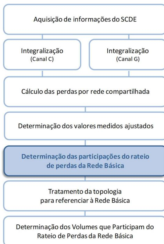
Figura 18: Esquema Geral do Módulo de Regras: ""
