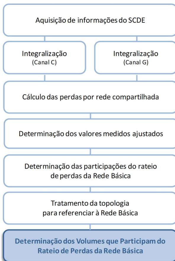
Figura 22: Esquema Geral do Módulo de Regras: "Medição Física"
